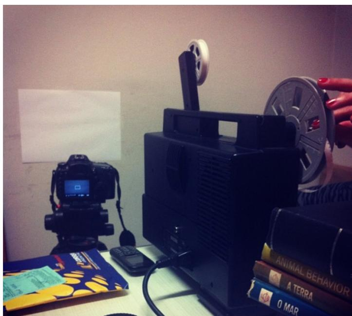
**Figura 6-** Exemplo de estrutura de digitalização montada, de modo improvisado, para a filmagem de uma projeção em Super8mm
