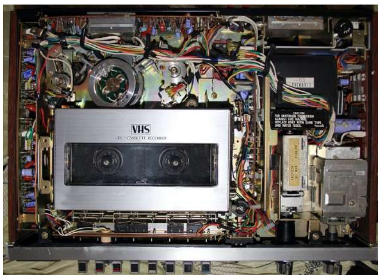
FIGURA 2: Por dentro do modelo JVC HR-3300, primeiro videocassete lançado pela JVC com formato VHS. Fonte: Wikipédia 2
